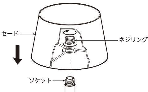
3. LED電球をソケットに確実に取付けてください。
